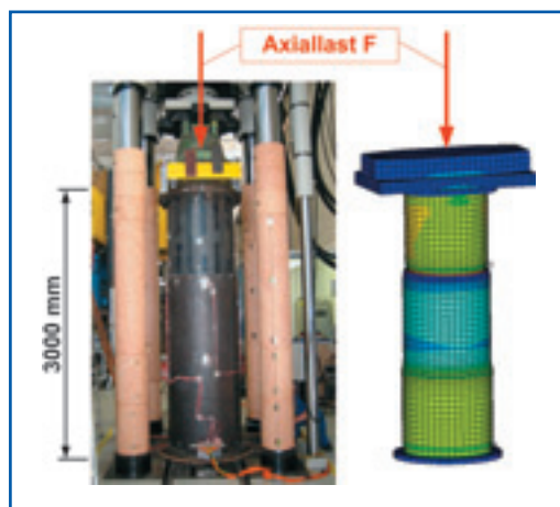
Bild 6 (links) Traglastversuch und numerische Simulation einer Gründungsstruktur Quelle: Institut für Stahlbau, Leibniz Universität Hannover
