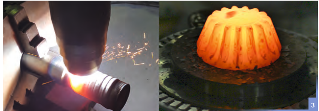
Abbildung 3 Links: Plasma-Pulver-Auftragschweißen, rechts: geschmiedetes hybrides Kegelrad Foto: IW/IFUM
