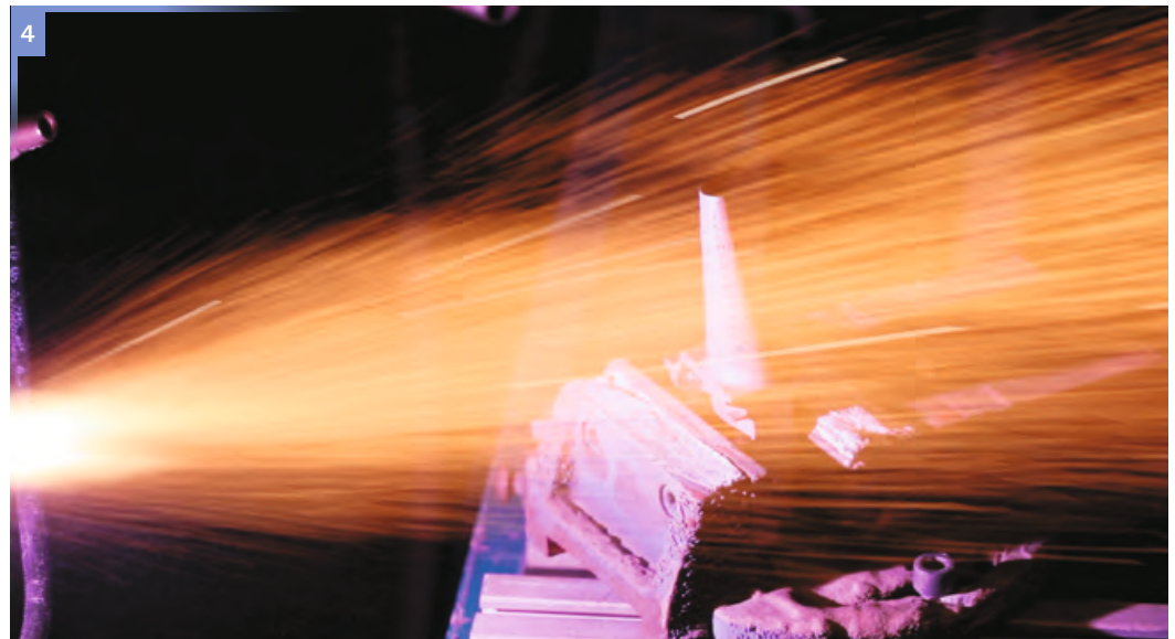
Abbildung 4 Beschichtung einer Turbinenschaufel mittels atmosphärischen Plasmaspritzens
