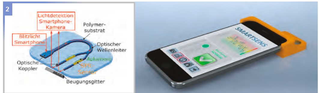
Abbildung 2 Die SmartSens-Technologie – Prinzip (links) und Gestaltungsform des Sensors (rechts).
