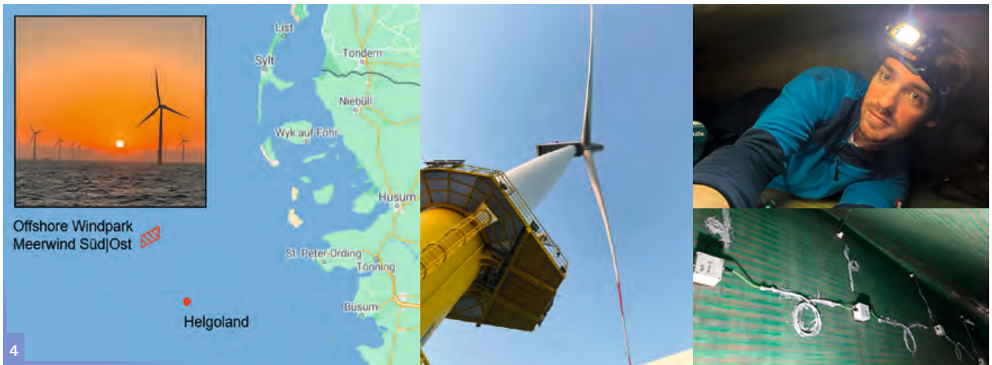
Abbildung 4 Offshore-Messkampagne im Projekt MultiMonitorRB zur Strukturüberwachung und Schadensfrüherkennung bei Rotorblättern von Windenergieanlagen. Links: Lage des Offshore-Windparks Meerwind Süd|Ost. Mitte: 3,6 MW-Turbine im Windpark. Rechts: Applikation von Sensorik durch Mitarbeiter des Instituts für Statik und Dynamik. Bildgestaltung vom Institut für Statik und Dynamik. Fotos: mit freundlicher Genehmigung von WindMW, Fraunhofer IWES und ISD
