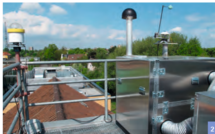
Abbildung 2 Das weltweit einmalige schnelle Strahlungsmessgerät AMUDIS auf der Dachplattform des Instituts für Meteorologie. In der schwarzen Kuppel befindet sich die Eingangsoptik mit 500 Lichtwellenleitern, mit der die UV, infrarote und sichtbare Strahlung aus etwa 150 Himmelsrichtungen hochaufgelöst und gleichzeitig erfasst werden kann. Foto: Holger Schilke
