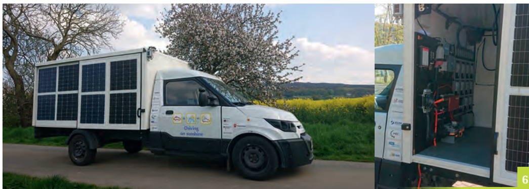
Abbildung 6 Aufgebautes Demonstrator- Fahrzeug mit Leichtbau-Solar- modulgeneration Foto: ISFH
