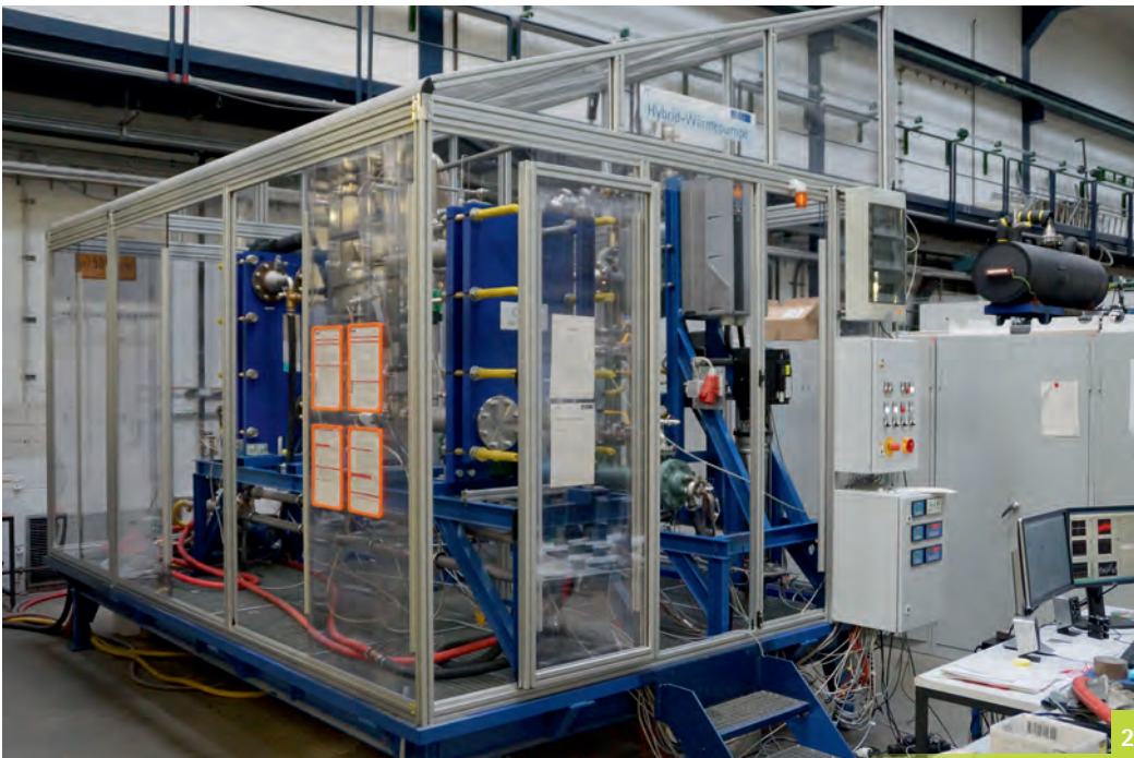
Abbildung 2 Die Ammoniak/Wasser Hochtemperatur-Technikums-WP Anlage am IfT Foto: IfT
