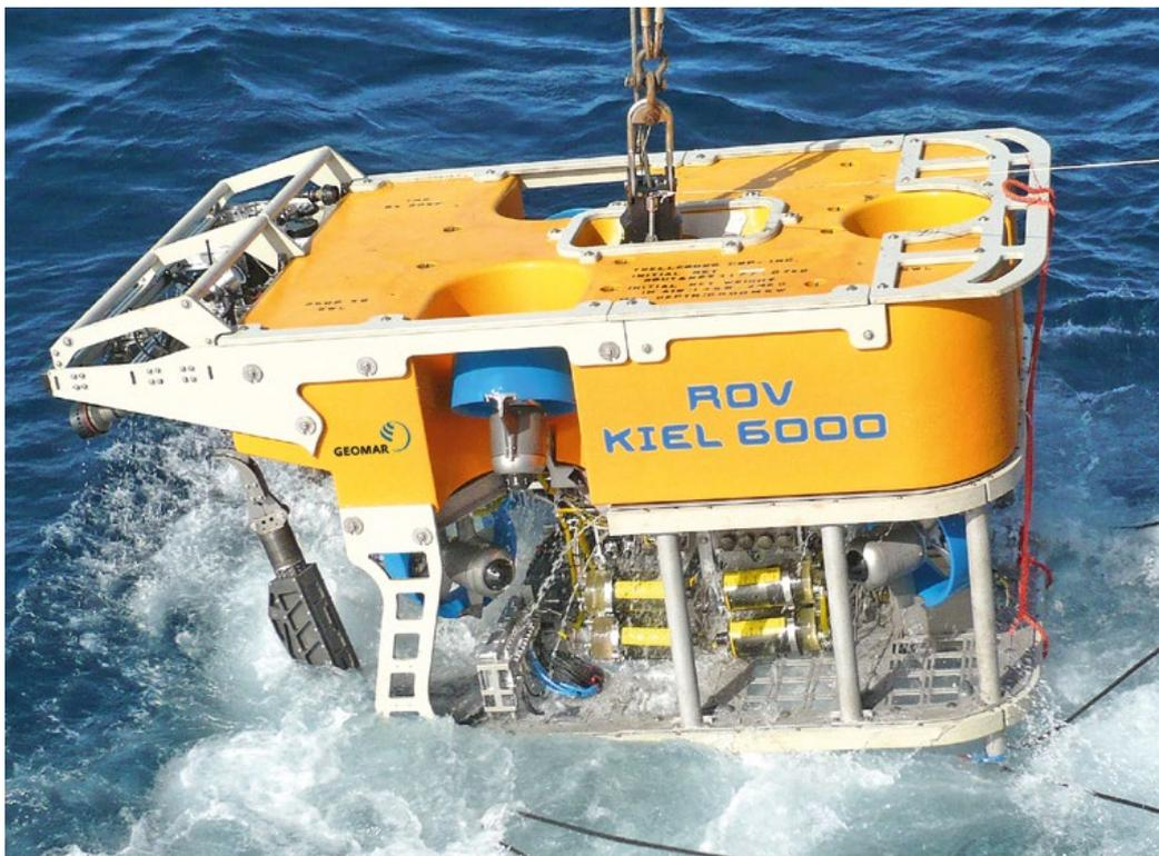
In einem ferngesteuerten Unterwasserfahrzeug wird ein spezielles Lasersystem (LIBS) getestet. Zukünftig soll es in einem autonomen Unterwasserfahrzeug Bodenschätze in der Tiefsee aufspüren.
