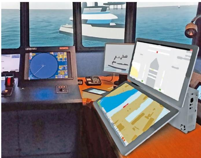
Durch die mobile Evaluationsplattform lassen sich Assistenzsysteme in verschiedenen Umgebungen testen.
