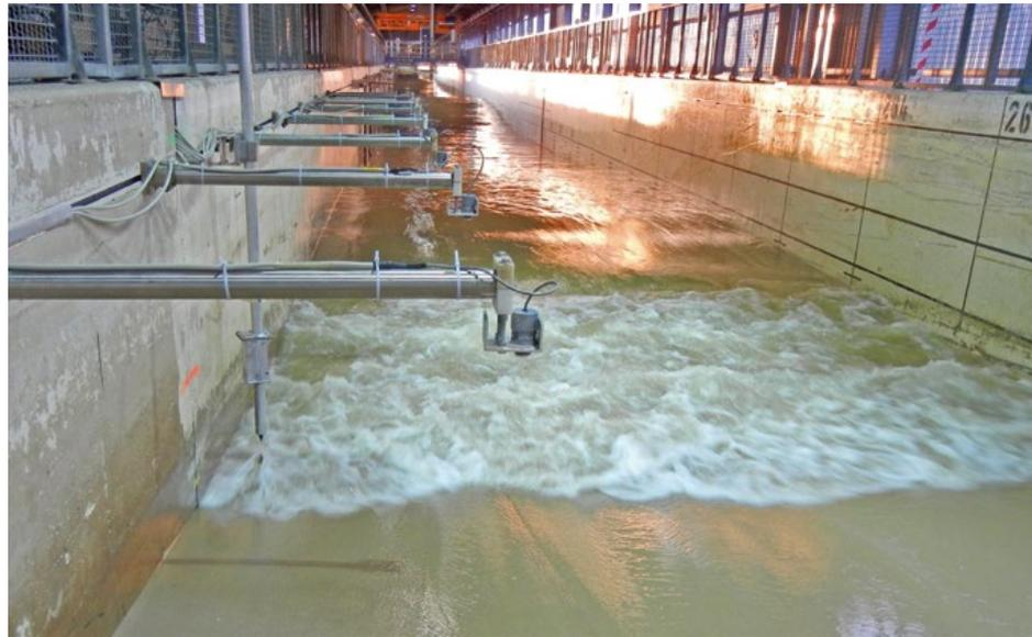
Im Großen Wellenkanal in Hannover kann der küstennahe Sedimenttransport unter Sturmflutbedingungen modelliert werden.
