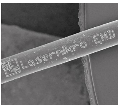
Ein mit ultrakurzen Laserpulsen beschriftetes Haar
