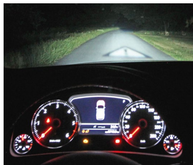
Kontrastreiche Symbolprojektion mit einem hochauflösenden Scheinwerfer
