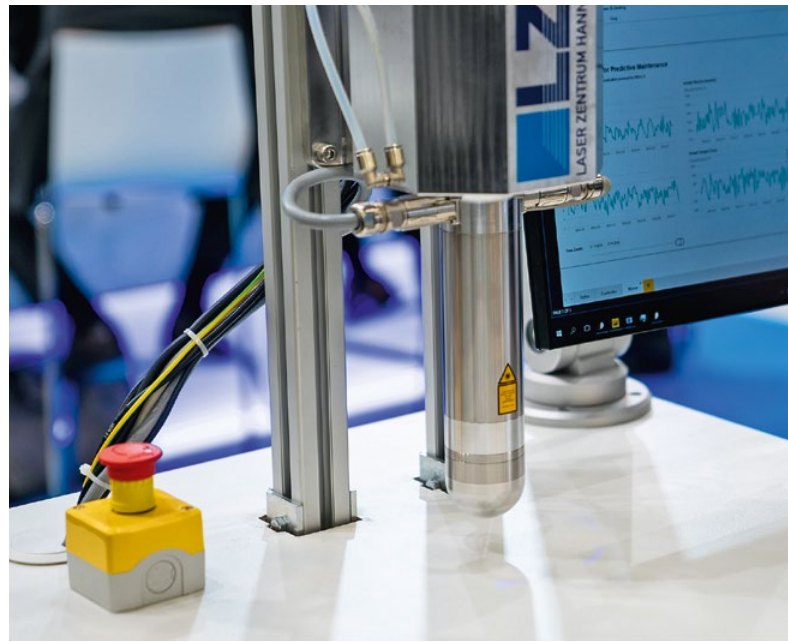
Innovative Systemtechnik zur Laserbearbeitung von innenliegenden Flächen
