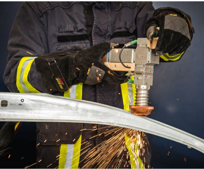
Handgeführter Laserschneidkopf zur schnellen Rettung verletzter Personen
