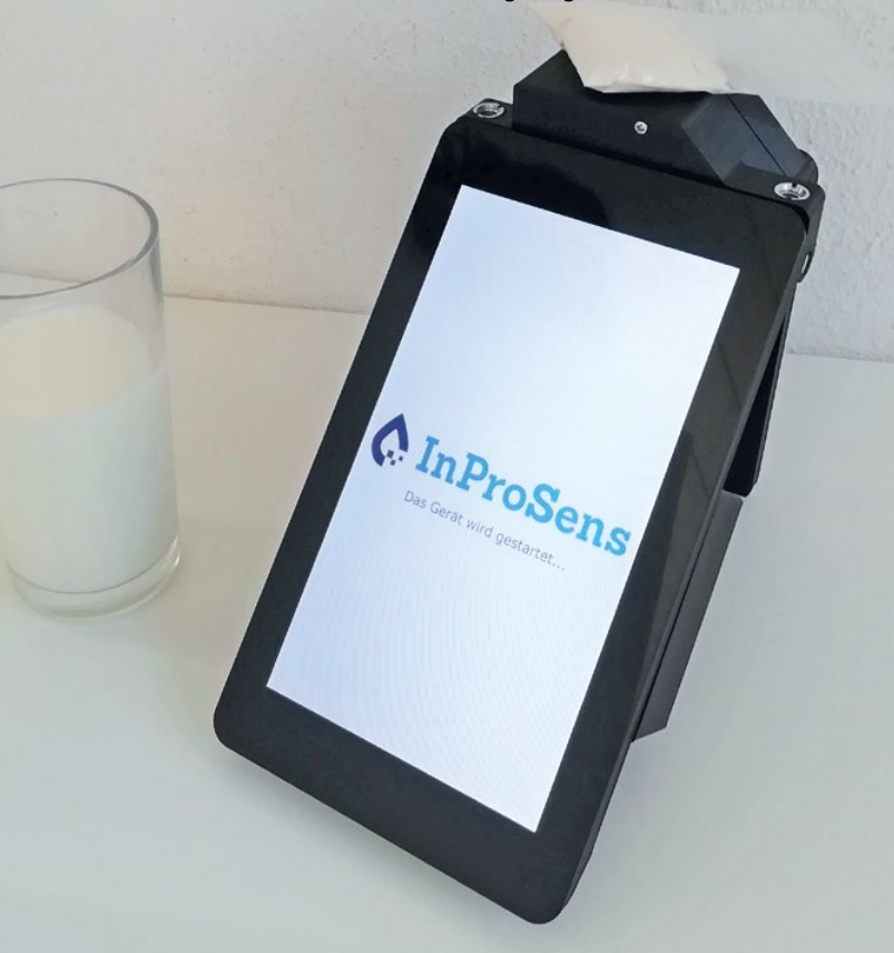
Der Infrarotsensor NIRScreen untersucht beim Milchpulver Kontaminationen durch Melamin.
