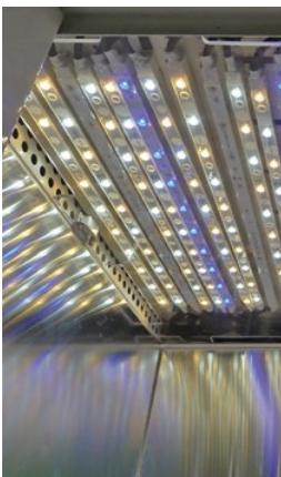
Bei der LED-Beleuchtung in der Klimakammer am Institut für Botanik lassen sich die Wellenlängen und Intensität variieren.
