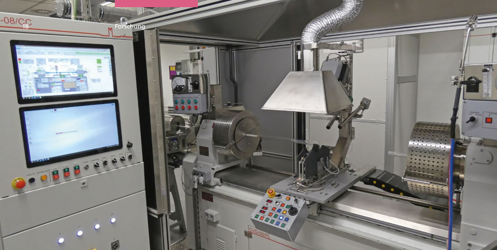
Modified Chemical Vapor Deposition (MCVD)-Anlage am HITec der Leibniz Universität Hannover zur Erforschung neuartiger Faserkonzepte und strahlungsharter Fasern
