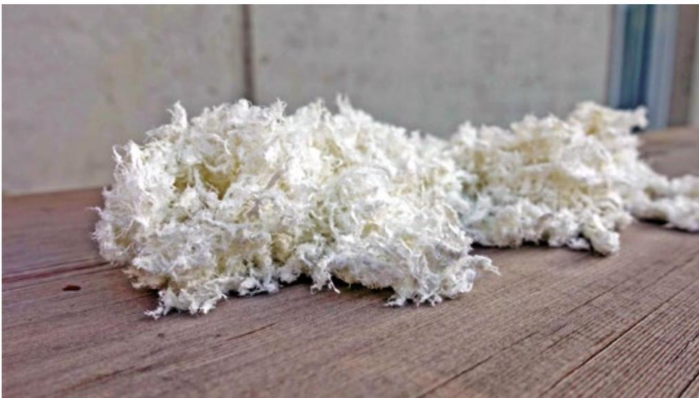
Die Fasern der Ananas-Blätter enthalten wenig Lignin. Aus diesem Grund kann mit schonenden Verfahren die Cellulose für Zellstoff extrahiert werden.
