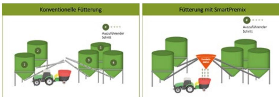
Bei der konventionellen Futtermischung werden die Komponenten einzeln und nacheinander über Förderschnecken in den Mischwagen geladen – das ist zeitaufwändig und ungenau. Die neue Vormischstation des Start-ups automatisiert diesen Prozess.
