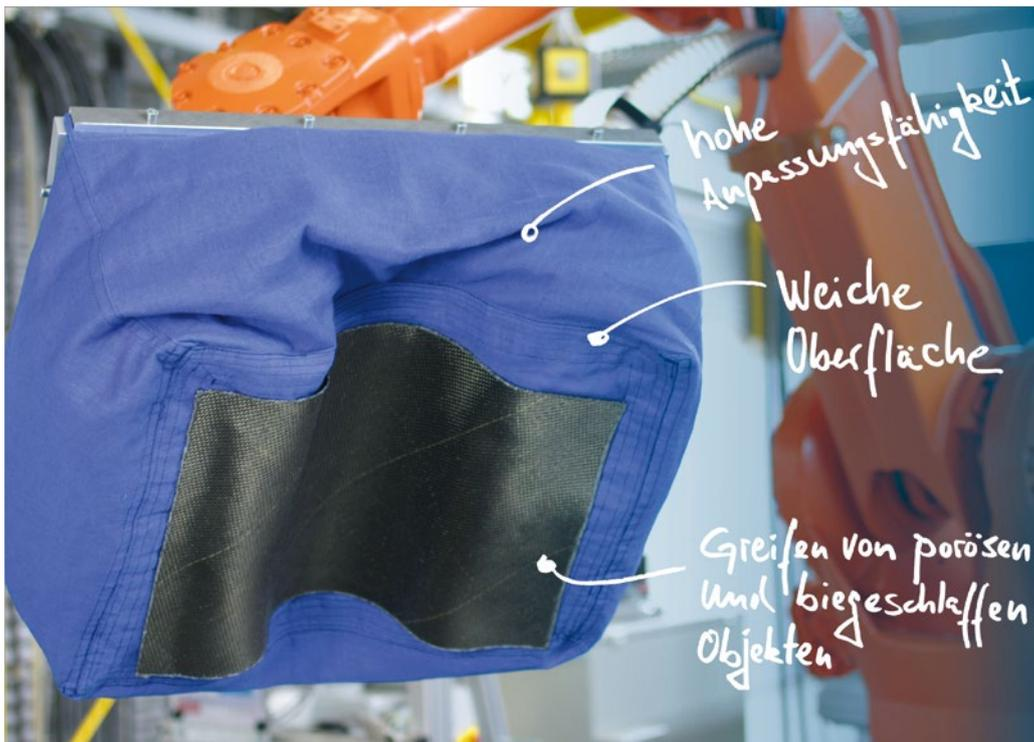
Das FormHand-Greiferkissen passt sich selbsttätig an verschiedene Geometrien an – hier an einen schwarzen Textilstuschnitt. So sorgt er für effiziente Handhabungsprozesse in einer variantenreichen Produktion.
