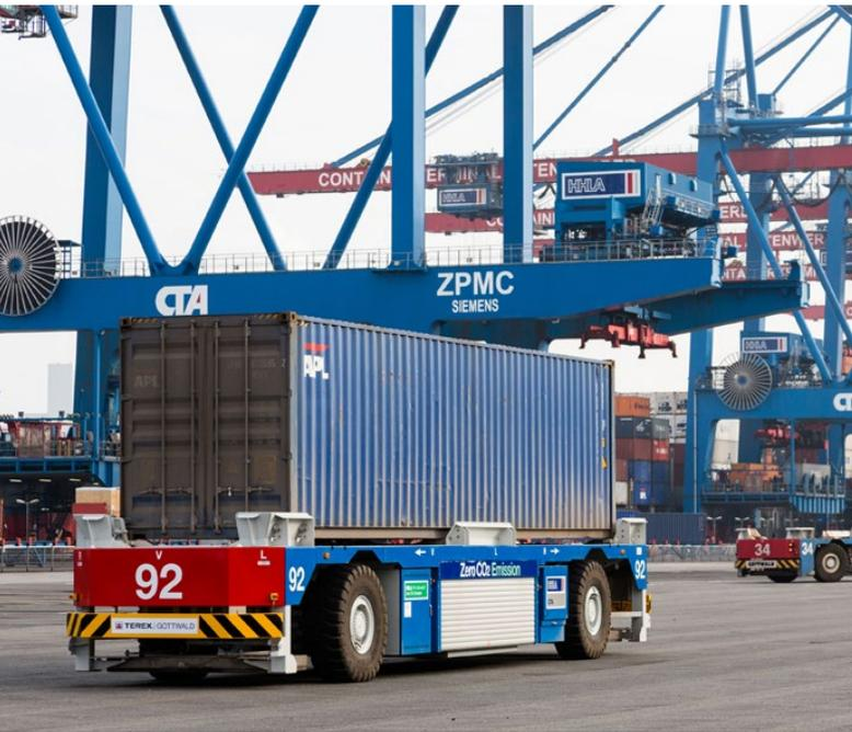
Zwischen Containerbrücken und Lagerblöcken werden Container mit autonom fahrenden, batteriebetriebenen Transportern bewegt.
