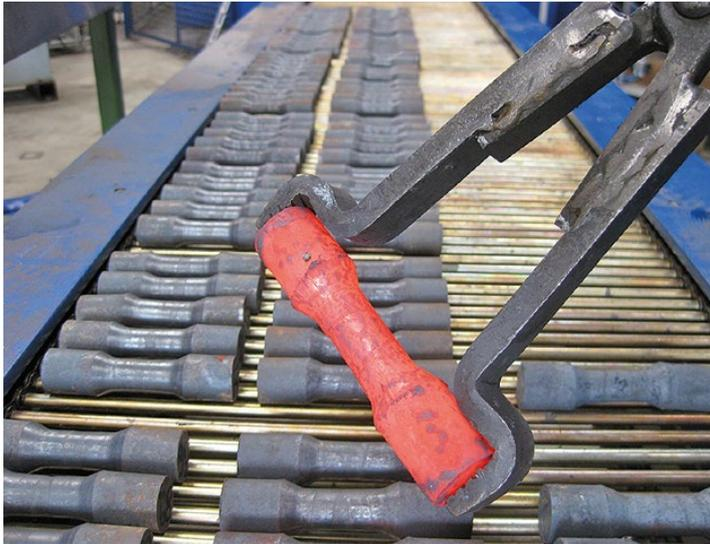
Durch Querkeilwalzen lassen sich rotationssymmetrische Vorformen herstellen – ohne Materialverlust.
