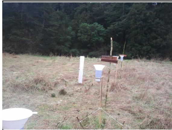
Abbildung 2: SIAs und Pluviometer mit Nylonfäden in Puyehue
