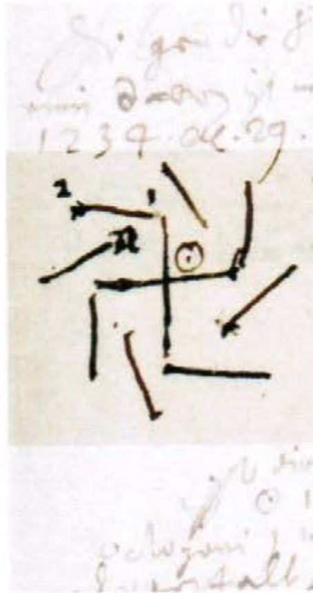
Abb. 20 a und b: Prinzip der horizontalen Windmühle im Grundriss. a) Links: Zeichnung von Leibniz' Hand, Ausschnitt aus Abb. 19, Skizze am linken Rand (Gottfried Wilhelm Leibniz Bibliothek Hannover, GWLB: LH XXXVIII, Bl. 313r); b) Rechts: Funktionsweise, rot der innere Rotor, schwarz die äußeren feststehenden Leitschirme (Zeichnung: Gabriele Herbst).
