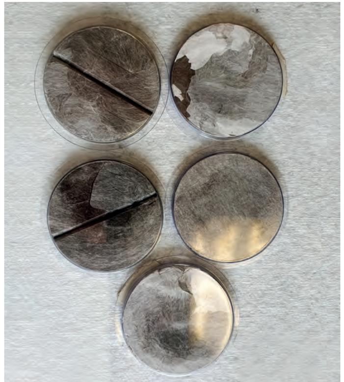
*Die Luftfilter enthalten neben atmosphärischen Staubpartikeln auch das radioaktive Material. Durch die Analyse der Filter konnte das Ausmaß der Freisetzung und die isotopische Zusammensetzung der Wolke bestimmt und daraus das Alter des radioaktiven Materials berechnet werden.*
