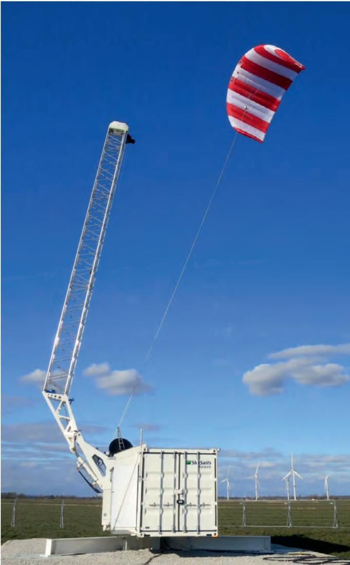
Im Probetrieb: Die erste Höhenwindenergieanlage Deutschlands bei Klixbüll in Schleswig-Holstein. (Foto: Skysails)
