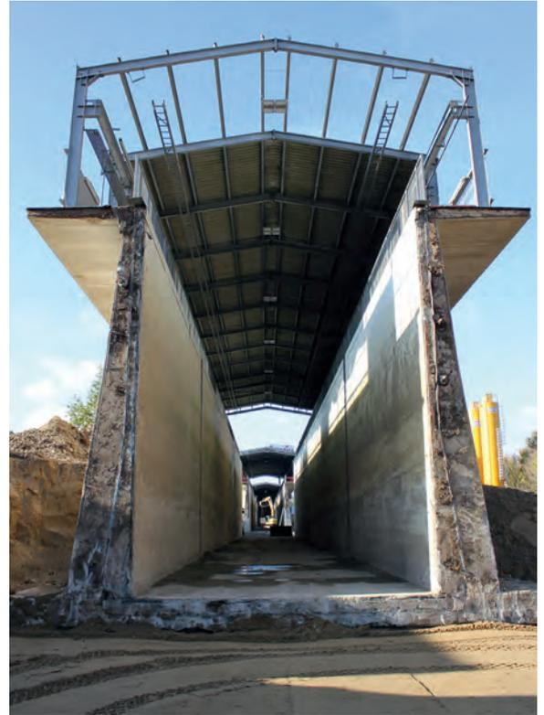
*Wird mit neuem Tieftteil, neuer Strömungsanlage und leistungsfähigerer Wellenmaschine ausgestattet: Der große Wellenkanal in Marienwerder. © Forschungszentrum Küste*
