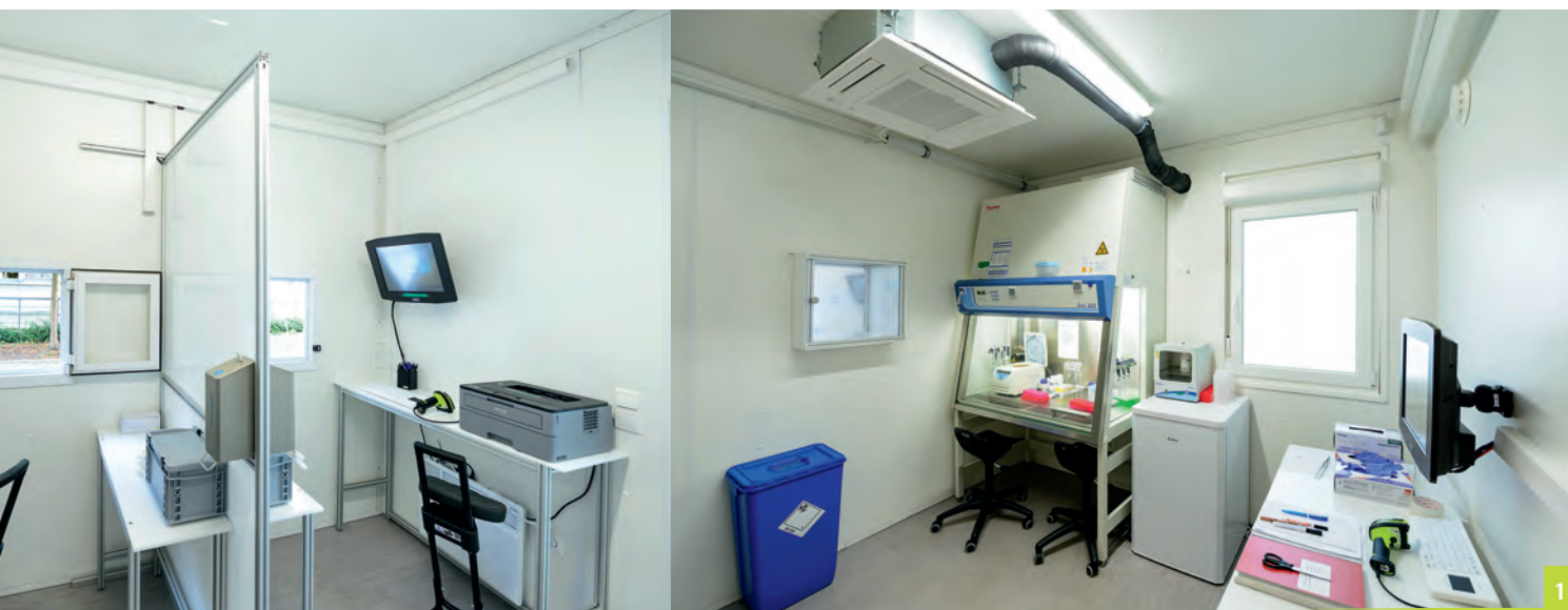
Abbildung 1 Mobiler Containeraufbau als Teststation: Außenansicht (links), Abstrichstation innen (mitte) und Labor der Schutzstufe 2 (rechts). Quelle: LUH
