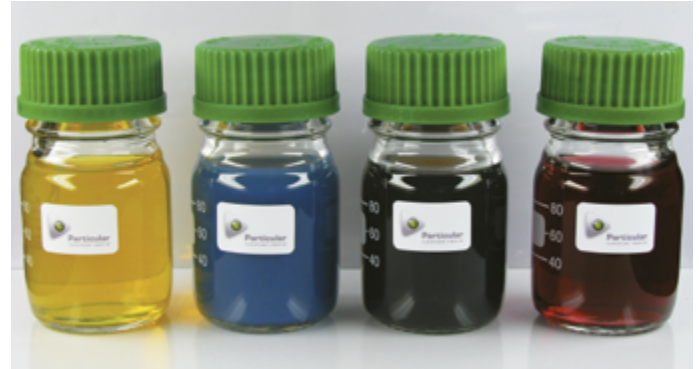
Silber-, Titan-, Platin- und Gold-Kolloide: Die Flüssigkeiten verändern je nach zugesetztem Metall die Farbe. Je nach Kundenwunsch können die Partikel verschiedene Größen im Nanometerbereich haben, auch die Konzentration ist variabel.
