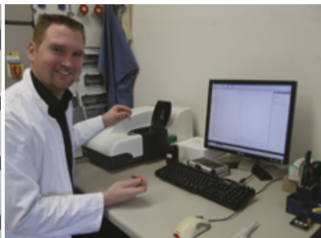
Qualitätskontrolle: Bevor die fertigen Kolloide zum Kunden gehen, wird geprüft, ob die Partikel tatsächlich die gewünschte Größe haben.
