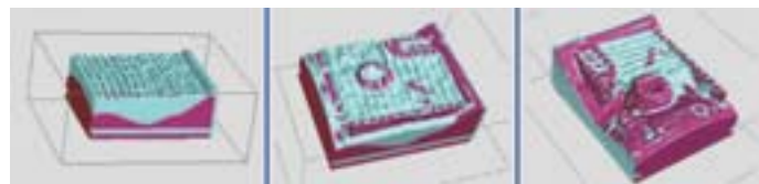
Abbildung 8 Verschiedene Bearbeitungszustände eines Beispielbauteils mit Fertigteilgeometrie (rot) und Restmaterial (blau)
