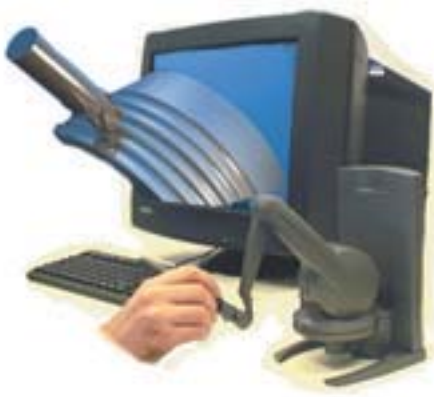
Abbildung 7 Haptisches 3D-Eingabegerät und stereoskopischer Monitor zur Unterstützung der NC-Programmierung
