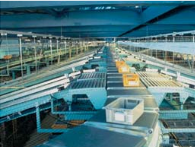
Bild 7 Crossbelt-Sorter zur Warenverteilung (Mannesmann Dematic, Wetter)
