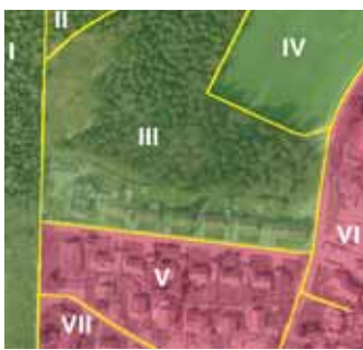
Abbildung 4 Exemplarische Analyse im Hinblick auf Siedlungsgebiete und Vegetationsflächen: (links) erwartete ATKIS-Objekte (nummeriert) und (rechts) Ergebnis der automatischen Analyse
