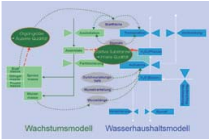
Abbildung 9 Schematische Darstellung eines gekoppelten Pflanzenwachstums- und Wasserhaushaltsmodells mit Schnittstellen für die Modellierung innerer und äußerer Qualitätseigenschaften
