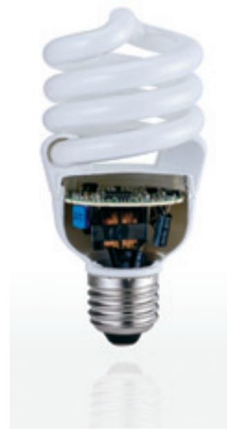
Abbildung 5 Energiesparlampe mit geöffnetem Sockel, der die Leistungselektronik enthält. Die ebenfalls enthaltene Steuerungselektronik ermöglicht eine elektronische Dimmung. Quelle: Paulmann
