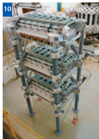
Abbildung 10 Teilaufbau einer Multilevel-HGÜ im Hochspannungstest. Zu sehen ist ein Teil eines Brückenzeigs. In jeder Etage sind mehrere Module nebeneinander angeordnet, in einer Anlage bilden mehrere dieser Aufbauten einen Brückenzeig. Quelle: Siemens
