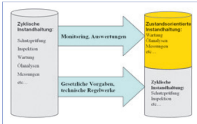
Bild 3 Entwicklung von der vorbeugenden in die zustandsorientierte Instandhaltung Quelle: Transformer Life Management Tagung 2008 des Schering-Instituts, Beitrag V. Seitz
