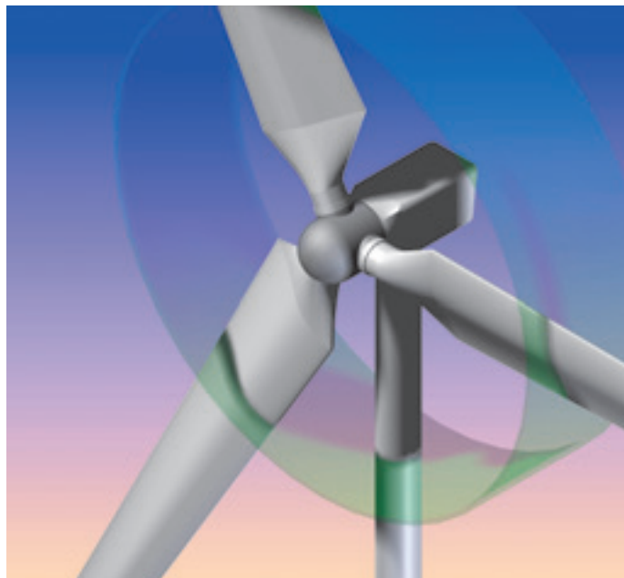
Bild 10 Turm- Blatt Interaktion einer WEA Quelle: Institut für Turbomaschinen und Fluid-Dynamik, Leibniz Universität Hannover
