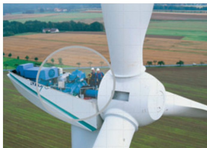
Bild 8 Getriebe im Zentrum des Antriebsstranges einer WEA Quelle: REpower
