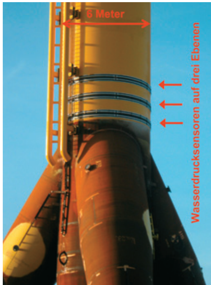
Bild 5 Tripod (Multibrid) mit Messsystem Quelle: DEWI (2008)
