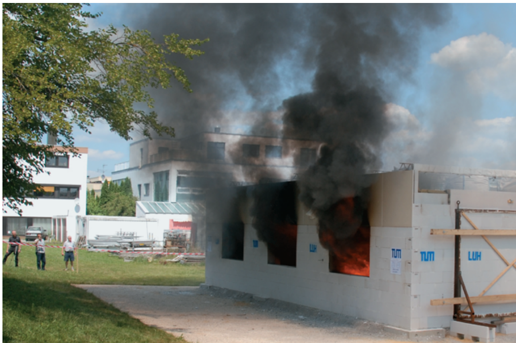
Abbildung 5 Großbrandversuch zum Tragverhalten von Decken im September 2010. Gemeinsames Projekt der TU München und der Leibniz Universität
