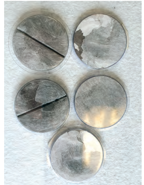
Die Fotos zeigen ein Filterstück bei Extraktionsversuchen in einer Spritze (oben links), eine Übersicht der radioaktiven Luftfilter (rechts) sowie eine Aufnahme bei den thermischen Experimenten im Ofen (unten).
