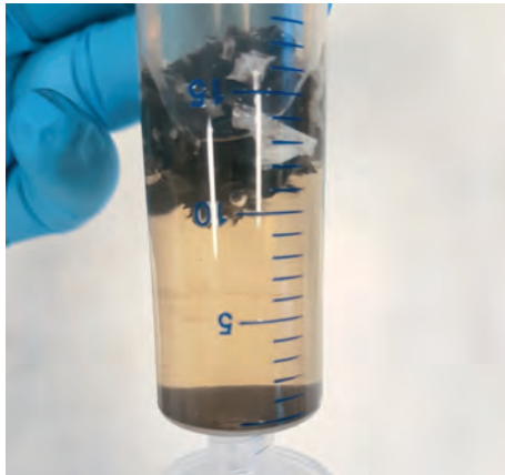
Die Fotos zeigen ein Filterstück bei Extraktionsversuchen in einer Spritze (oben links), eine Übersicht der radioaktiven Luftfilter (rechts) sowie eine Aufnahme bei den thermischen Experimenten im Ofen (unten).
