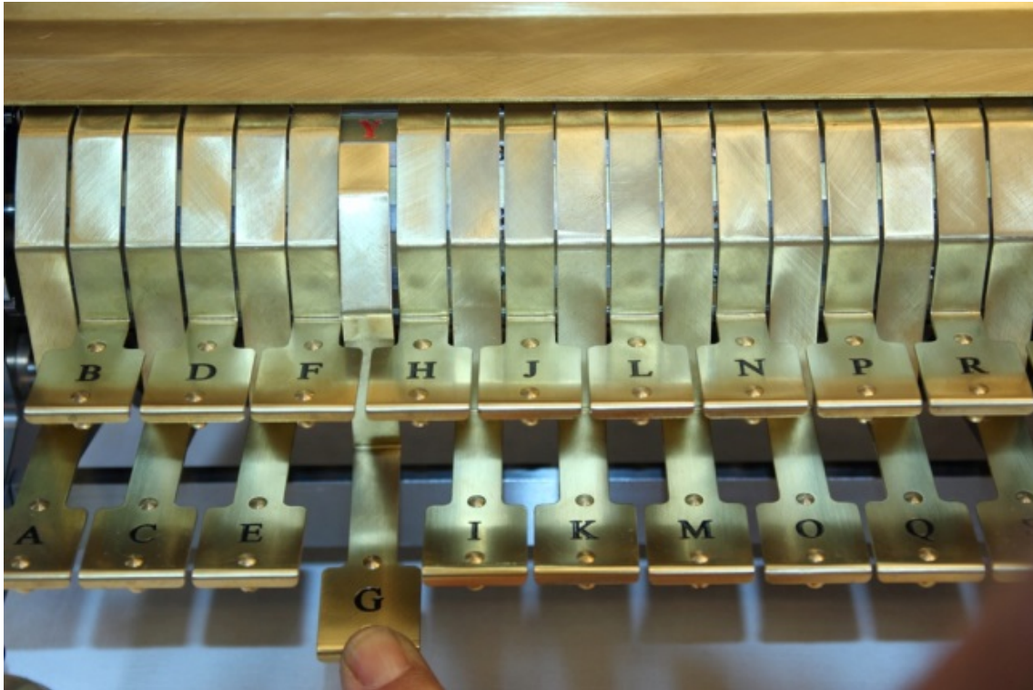
Bild 6: Machina Deciphatoria nach G.W. Leibniz' Vorschlägen, gedrückte Buchstabentaste G und entschlüsselter Buchstabe Y in der 4. Dekodierung
