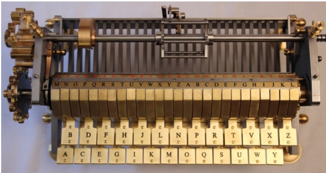
Bild 4: Machina Deciphtratoria (mechanische Chiffrier- und Dechiffriermaschine) nach G.W. Leibniz' Vorschlägen, ca. 1680-1700, Konstruktiver Entwurf von N. Rescher und R. Kotler, Detailkonstruktion von K. Badur, gebaut von G. Rottstedt, 2014
